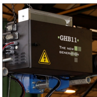
17 Armoire électrique palan
